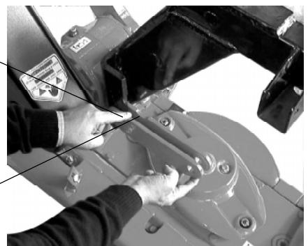
**16** Montare la lamiera convogliatrice interna con le apposite viti – *Mount the internal shroud plate with the relative screws* – Monter la tôle d’amenage interne avec les vis prévues à cet effet – *Das interne Schwadleitblech mit den dafür vorgesehenen Schrauben montieren* – Montar la chapa de transporte interna con los respectivos tornillos.
