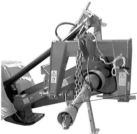
**29** Montare albero cardanico – *Mount driveline* – Monter l'arbre à cardans – *Gelenkwelle montieren* – Montar árbol cardánico.
